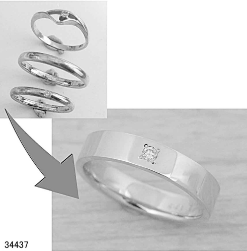
34437 3本の指輪を溶かし1本の太い指輪にリフォーム
